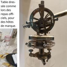
Théodolite: Instrument de mesures pour géomètres et cartographes
