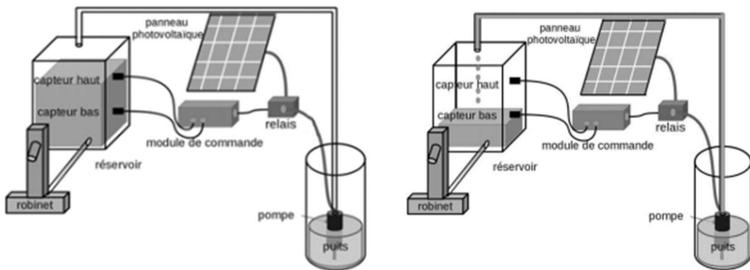
Lorsque le niveau de l'eau dans le réservoir atteint le capteur haut, l'ordre est donné d'arrêter la pompe.
