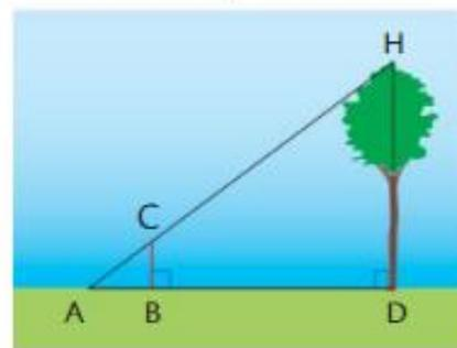
On utilise les ombres de l'arbre et d'un bâton pour déterminer sa hauteur selon ce schéma.
