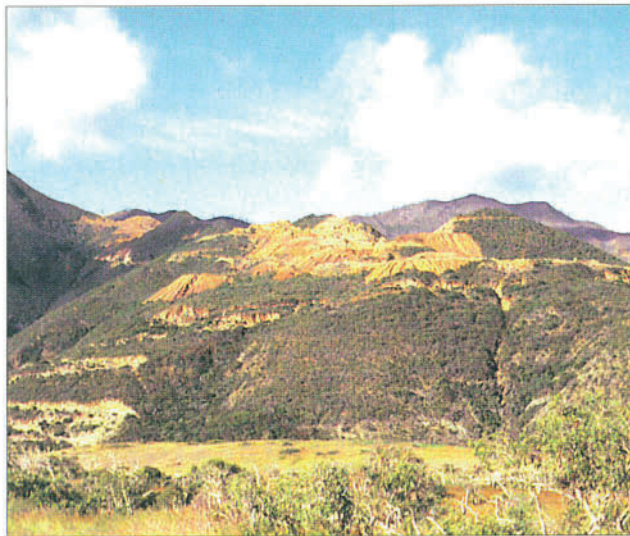
Site minier de L'Étoile du nord. Les traces d'une activité minière ancienne font apparaître un mode d'élimination des produits stériles qui n'a plus cours aujourd'hui. Ces matériaux étaient simplement déversés en haut d'une pente et dévalaient celle-ci à l'occasion de précipitations un peu fortes. La pollution minérale des rivières coulant en aval était inévitable. Depuis une vingtaine d'années les sociétés minières adoptent la technique de la décharge contrôlée qui consiste à stocker les stériles en bancs successifs, horizontaux et maintenus par un rempart de gros blocs de péridotites.
