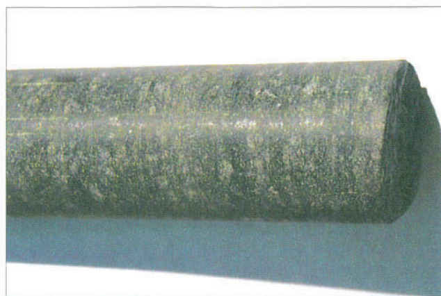
Carotte d'un forage réalisé sur le plateau de Thio. La partie la plus profonde du forage donne accès à des péridotites saines. La teinte verte, assez sombre, est due à la transformation des grains d'olivine en serpentine. Les taches plus claires sont des cristaux de pyroxène, plus résistants à la serpentinisation.
