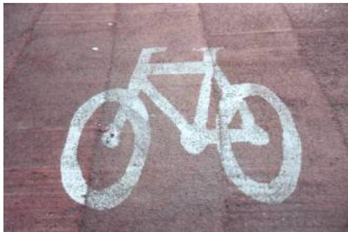
Les anamorphoses les plus courantes sont des schémas marqués au sol des chaussées, dont le vélo étiré est un exemple classique. Une construction très simple permet d'obtenir la figure déformée. Imaginons que le dessin original soit tracé sur un plan  $p$  formant un angle  $u$  avec le sol. On projette alors le dessin sur le sol suivant la direction perpendiculaire au plan  $p$ . La transformation est décrite analytiquement par :
