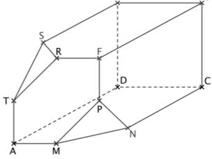
Les points désignés par une lettre majuscule *A*, *B*, *C*, *D*, ... sont nommés par la même lettre en minuscule a, b, c, d, ... dans la représentation en perspective centrale. Le segment [*BF*] est dans un plan frontal et le plan (*ABC*) est horizontal.
