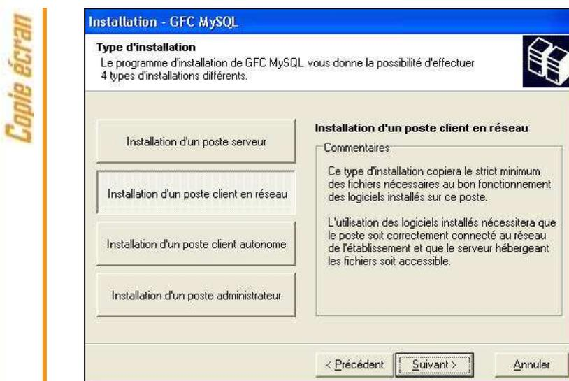
3 → CLIQUER SUR « Installation d'un poste client en réseau », PUIS SUR « SUIVANT > »
