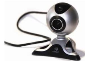
Certaines caméras possèdent des senseurs qui déclenchent automatiquement un éclairage d'appoint pour assurer une bonne qualité de l'image transmise. La caméra Web comporte une prise USB. Elle peut être branchée à l'avant du poste ou à l'arrière.
