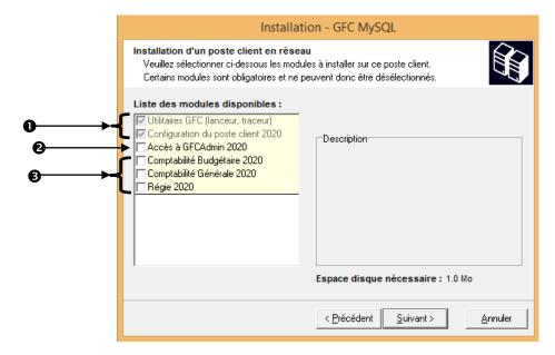
● Les cases répertoriées en • sont pré-cochées et non modifiables ; elles installent automatiquement l'accès au lanceur et au traceur.
