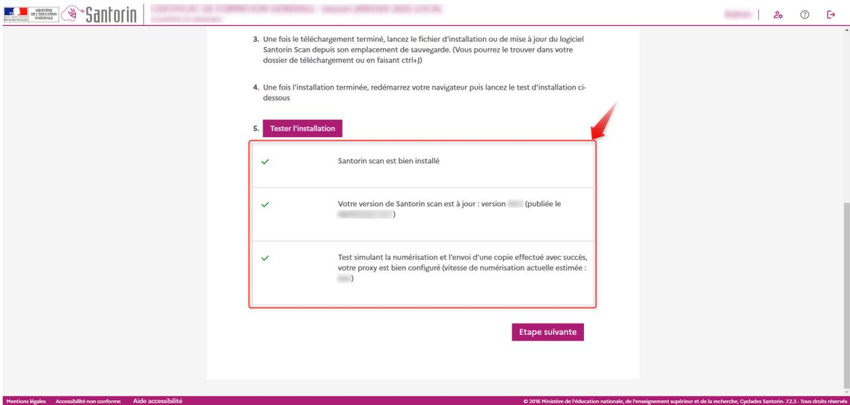
Lors de ce test, une simulation d'envoi d'une copie au serveur distant SANTORIN via « Santorin scan » est effectuée. Ceci permet de vérifier que la configuration du proxy lors de l'installation est correcte et que l'envoi d'un document numérisé arrive bien jusqu'au serveur distant. De plus lors de ce test, une estimation de la vitesse de numérisation actuelle est réalisée.
